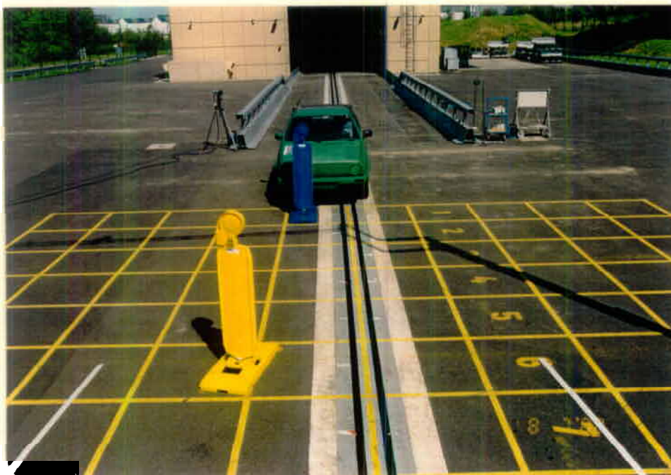
Anfahrsituation für Prüfung der passiven Sicherheit
